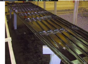
垂直尾翼用構造部材 (最大長さ 16メートル、出荷後の客先組立状態)
