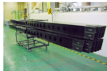
A380 二階席用構造部材 (長さ 7メートル、重さ 15kg)
